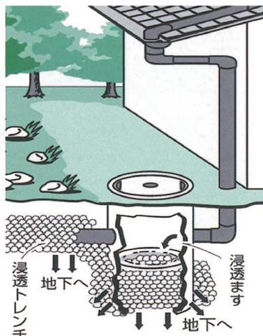
浸透枡で雨水を積極的に浸透させると下水道施設へ流れ込む雨水が減り、激しい雨の場合、1割程度の効果があると言われています。
