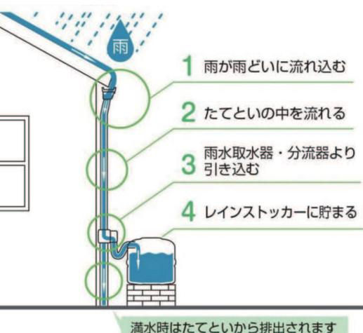
雨水を屋根から雨樋を通して集め、浄化したあと、タンクなどに溜め、散水・洗車・トイレの洗浄に再利用。
